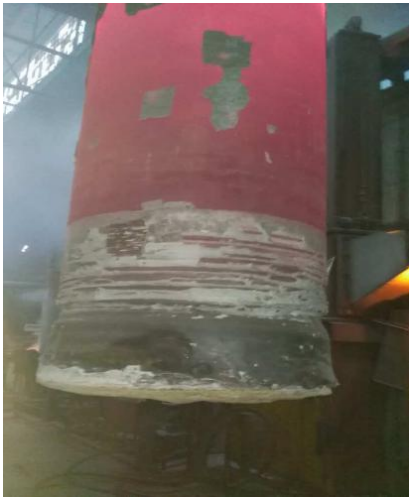
图1 电渣重熔后钢锭表面状况
