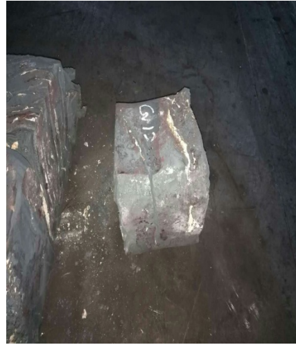
图2 钢锭在锻造过程中发生的断头现象
