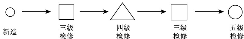
图1 动车组的高级检修实例
